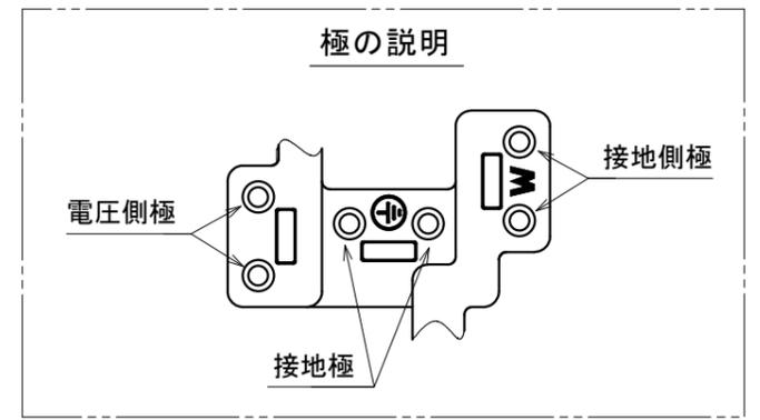
適用電線：銅単線 φ 1.6 mm、φ 2 mm
